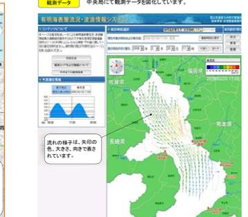
2局以上の観測局から扇状に発射されている電波が重なり合った範囲(電波照射範囲)※で、観測できます。(観測局=4局)
