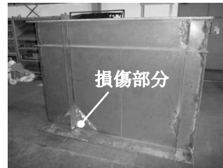
図-3 経年劣化した部材の試験体
