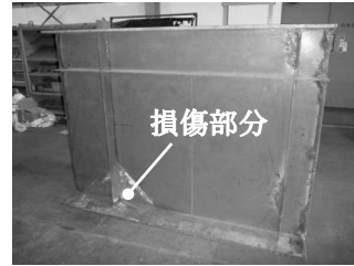
図-3 経年劣化した部材の試験体
