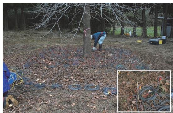
写真-1 比抵抗探査法における電極設置
