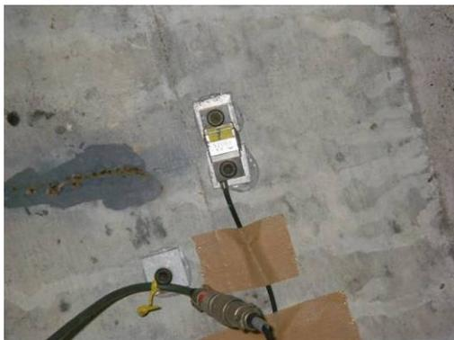
写真 2.3.11 ひずみ計設置状況
