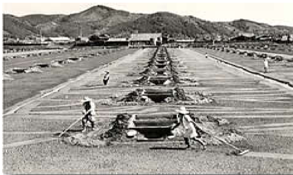
図 1.1.12 入浜式塩田による塩作り（昭和 28 年山口県防府市・財団方針塩事業センターHP）
