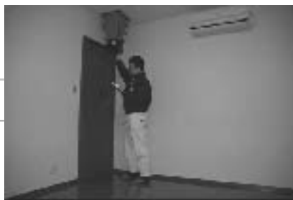
図10 風量測定器を用いた測定状況
