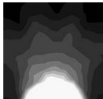
図 a 地面反射率が低く室内仕上げ面の反射率が低い場合
