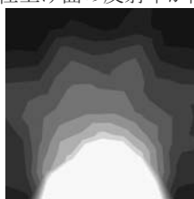
図 b 地面反射率が低く室内仕上げ面の反射率が高い場合(最も導光効果の高い場合)
