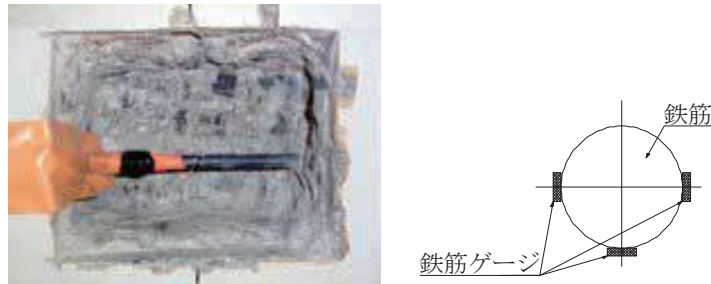
図 2.4.7 鉄筋のはつり出し切断
