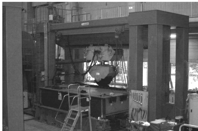
写真-4.3.1 輪荷重走行試験状況
