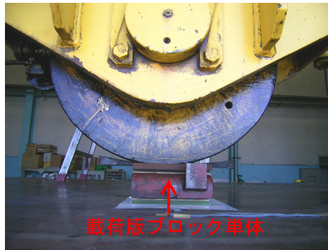
写真-3.2.2 載荷版ブロックごとの静的多点載荷
