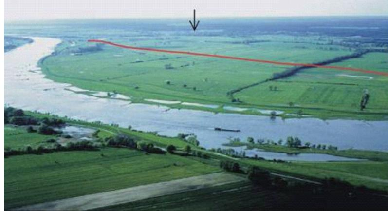
図 参-3 エルベ川の旧堤防の撤去と引堤
