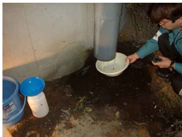
【路面排水の採水状況】
