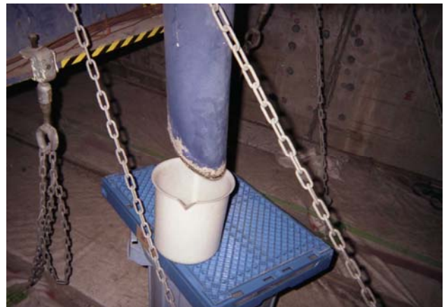
【路面排水の採水状況】
