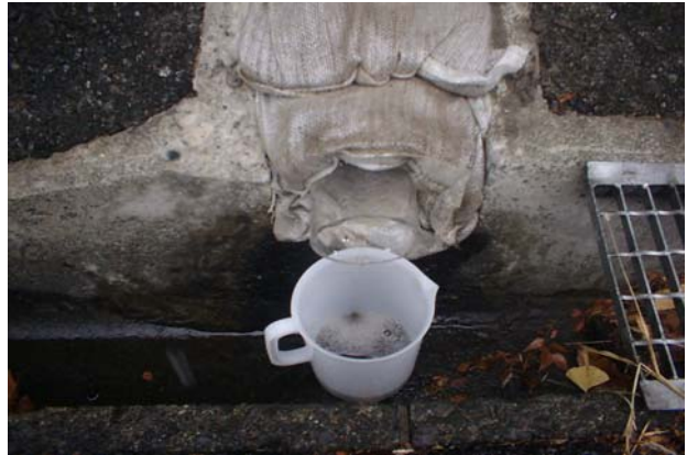
【路面排水の採水状況】
