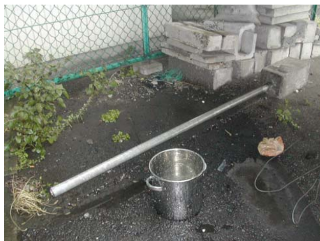
【路面排水の採水状況】
