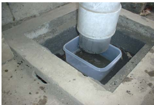
【路面排水の採水状況】
