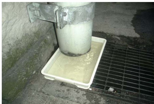
【路面排水の採水状況】
