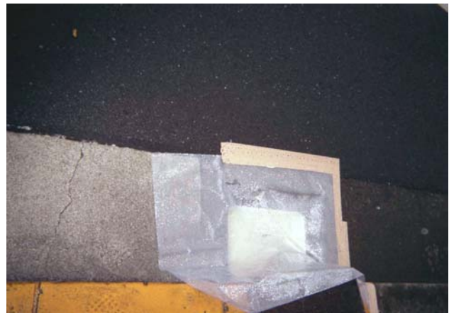
【路面排水の採水状況】
