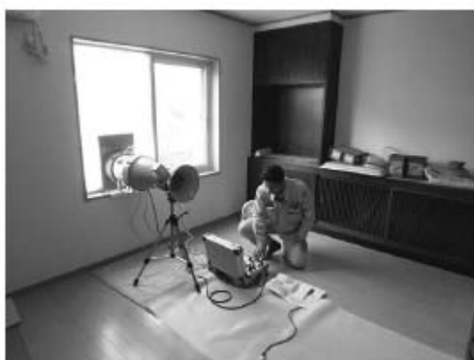
図 12 気密性能測定の様子
