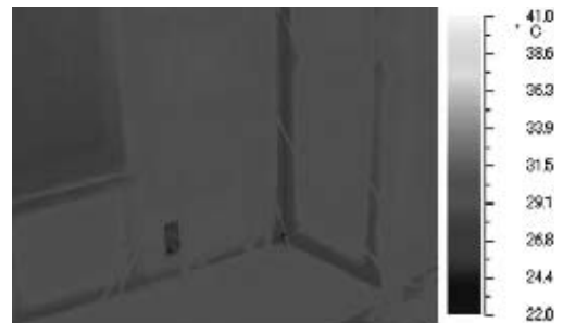
図 25 改修後(和室西戸境壁入り隅)(改修後:室内 31.5^{\circ}\text{C} 、外気 12.5^{\circ}\text{C} )
