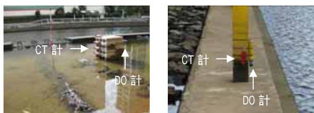
写真-9 機器設置状況
