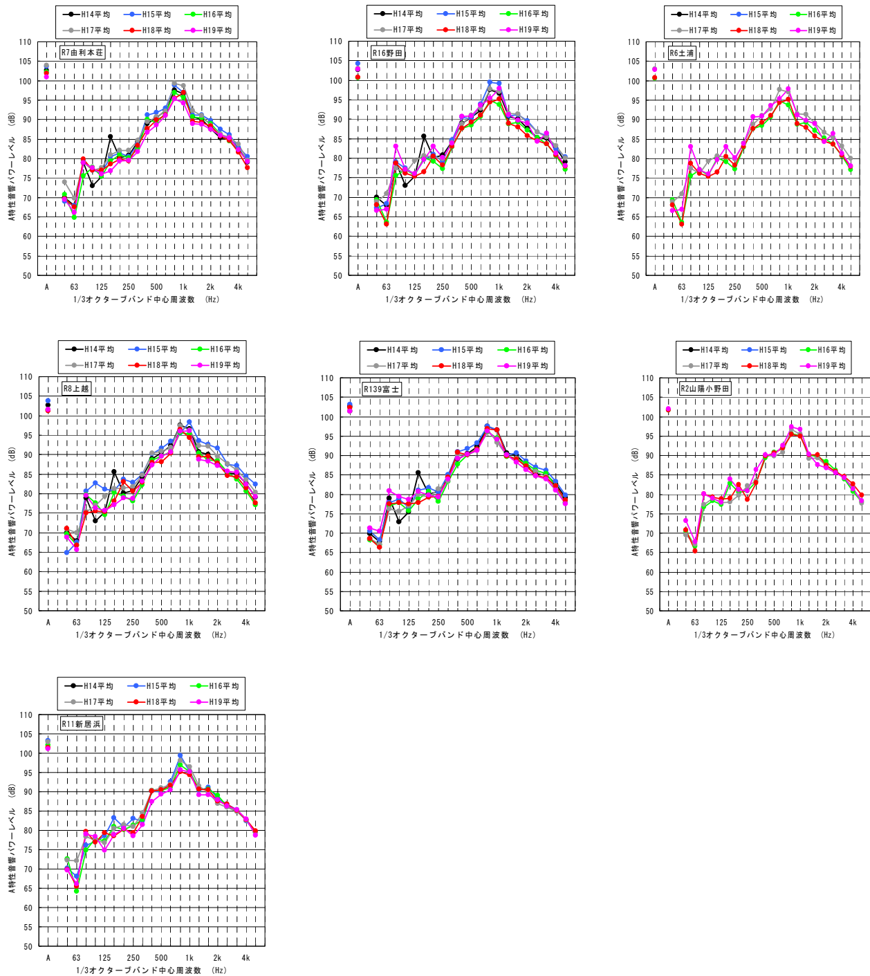
図 4-10(1) 大型試験車の A 特性音響パワーレベルの周波数特性（国総研試験走路）
