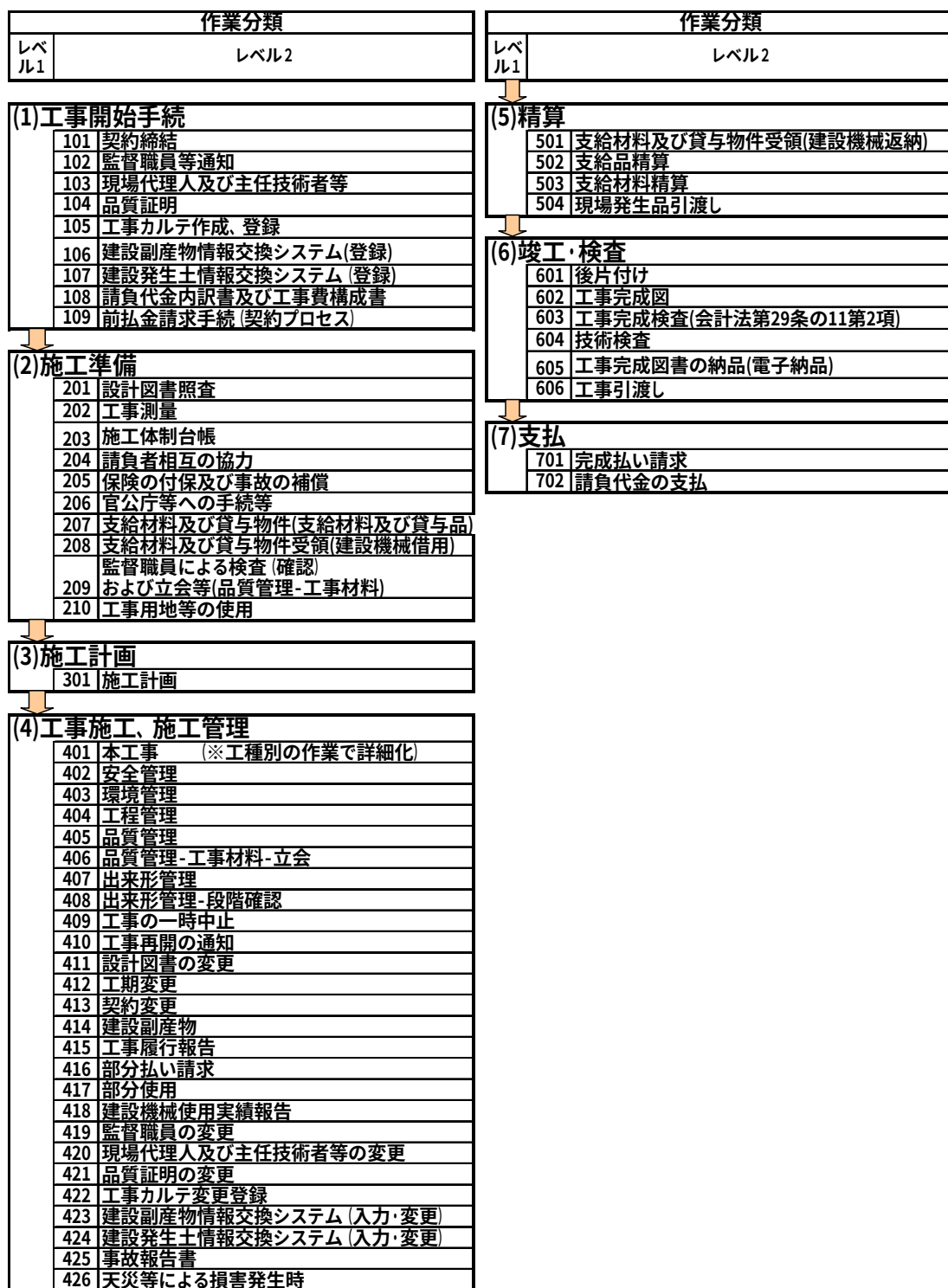
図 3-2 工事全体の作業分類（レベル 1、2）
