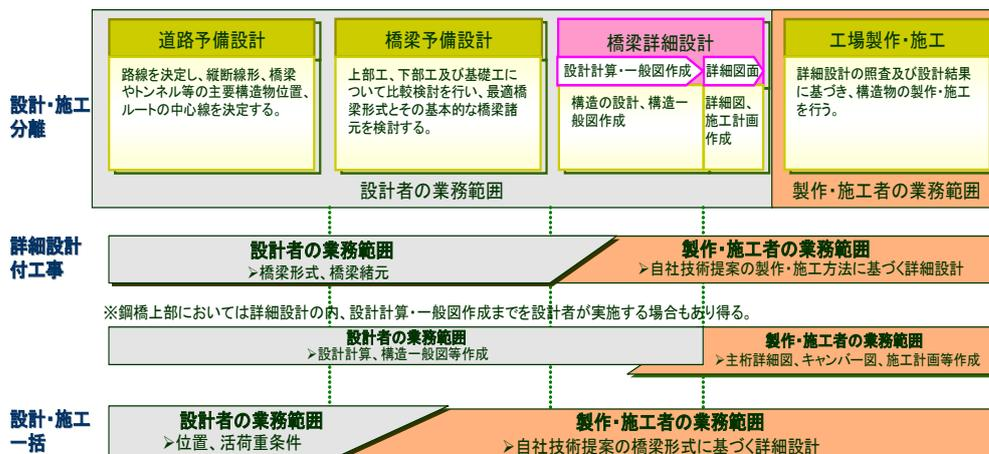
図5. 橋梁工事において設計・施工一括及び詳細設計付工事発注方式を採用した場合の設計者、製作者・施工者の役割分担の例
