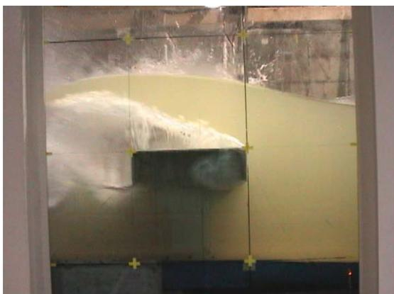
写真-4.2 水路実験において橋桁模型に衝突する孤立波
