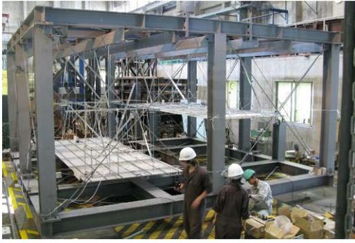
写真3 振動実験試験体
