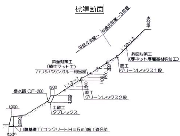
水谷山腹工：山腹基礎工の形式を斜面勾配により使い分けている。
