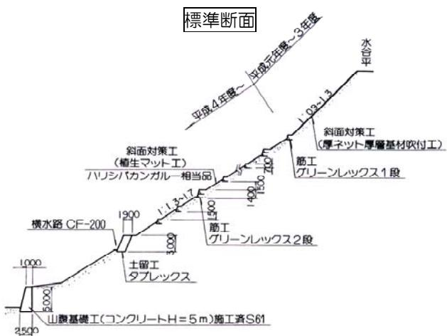
(16) 地形を的確に判断して斜面の表流水や伏流水の処理を確実に行う。
