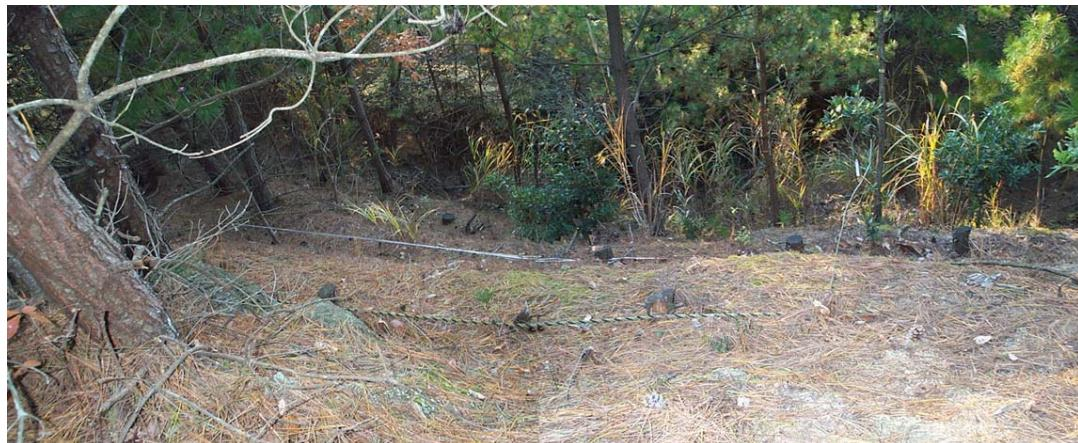
田上山腹工：皆伐試験を行い、植生の自然侵入を試みたが、光条件が良くても母樹がないため他の植生の侵入は見られなかった。その後、同一箇所で、広葉樹の植栽を実施したが成長が見られなかった。マツの葉が分解されずに下層に堆積して土壤が形成されていないことが要因であると推察される。
