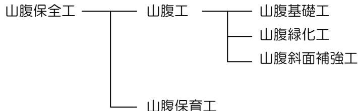
(2) 山腹斜面に侵食や崩壊がある場合には、山腹基礎工や山腹斜面補強工により山腹斜面の土砂の移動を抑えて植生の自然侵入を期待する。
