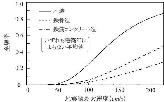
図-4.5 地震動最大速度と全壊率の関係
