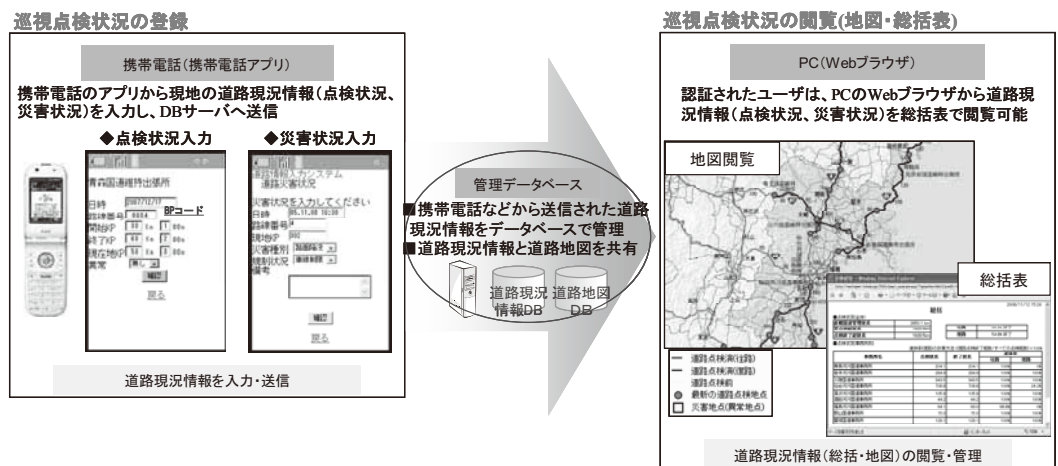
図ー1 道路点検状況把握システム
