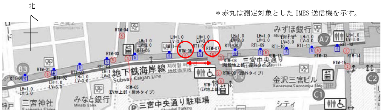
図-付 5.1. IMES 送信機の設置状況
