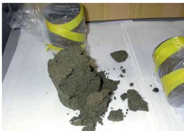
写真-3.4 サンプルング試料（脱型時）
