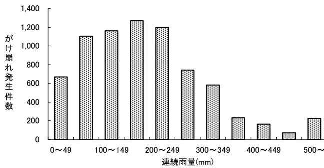
図-14.4.2 がけ崩れ発生までの連続雨量(台風) (昭和47年~平成19年)
