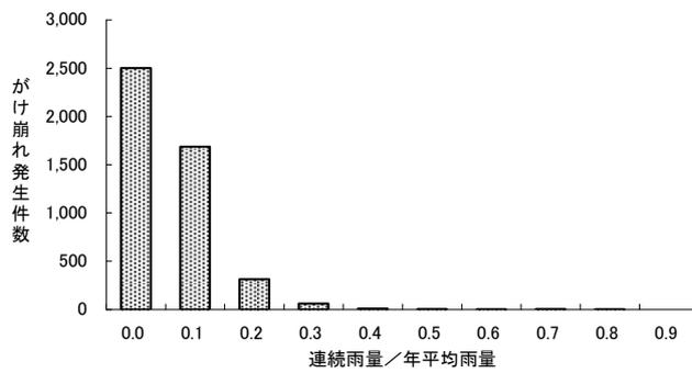
図-14.6.1.2 がけ崩れ発生までの連続雨量(台風) (昭和47年~平成11年)
