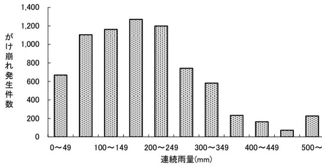
図-14.4.1 がけ崩れ発生までの連続雨量(台風) (昭和47年~平成19年)
