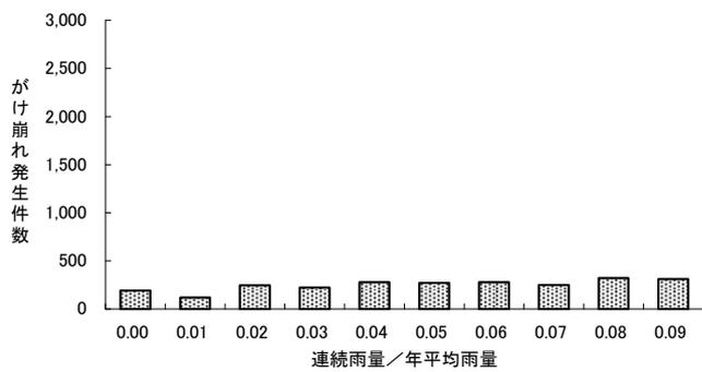
図-14.6.2.2 がけ崩れ発生までの連続雨量(台風)(昭和47年～平成11年)
