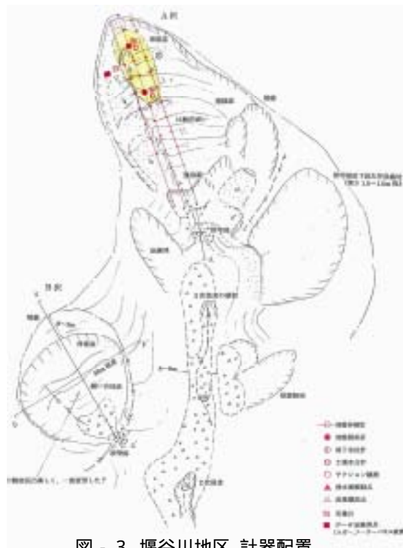
図 - 3 堰谷川地区 計器配置
