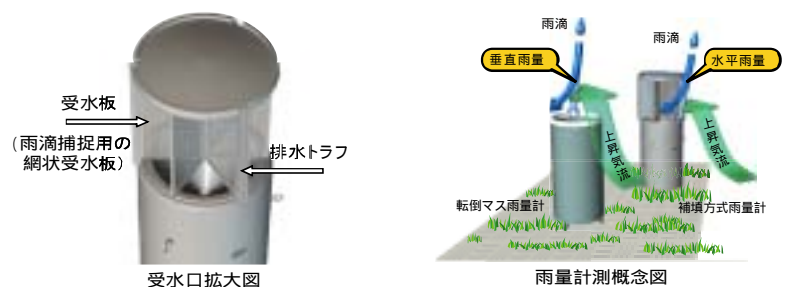
図 - 1 補填方式雨量計の観測精度向上方法 補填後の雨滴捕捉率変化
