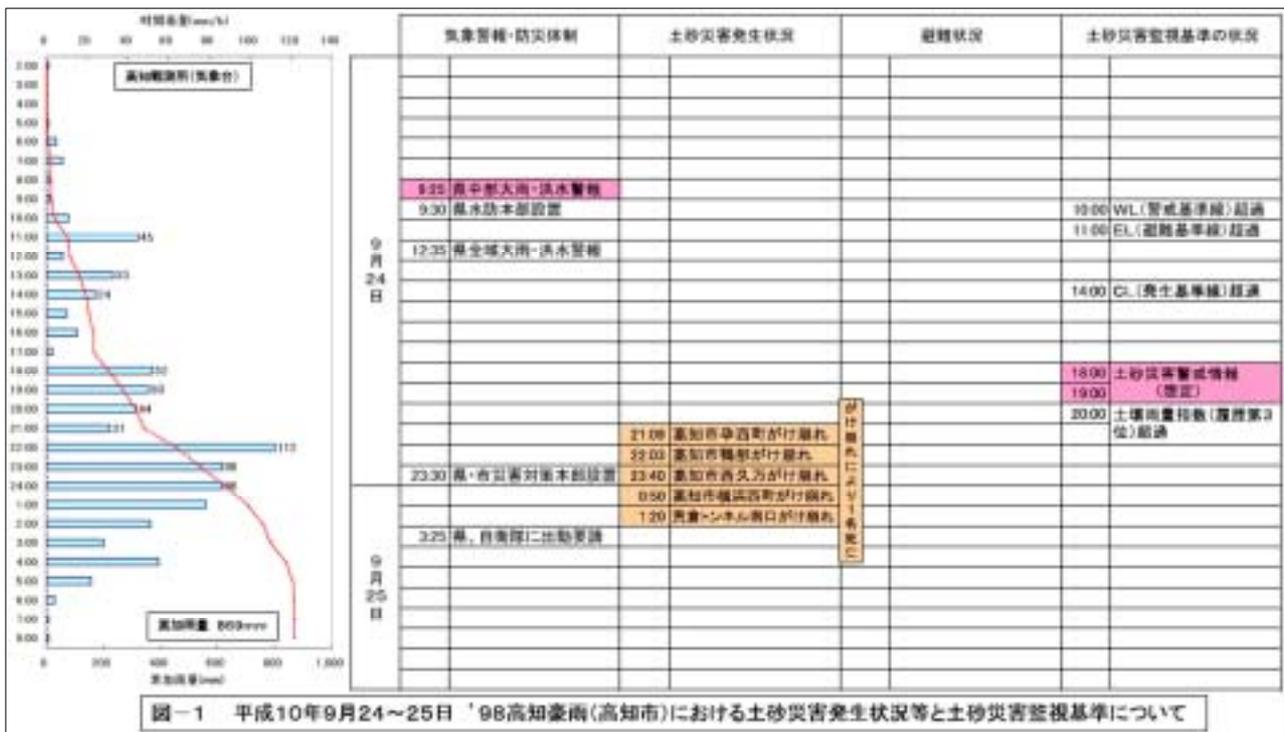
図-1 平成10年9月24～25日 '98高知豪雨(高知市)における土砂災害発生状況等と土砂災害監視基準について
