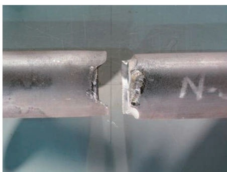
母材部の破断状況
