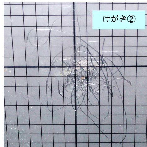
(a) I棟（左図：解析値・右図：5mmグリッドによる実測値）
