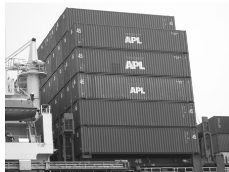
写真-3 甲板1段目から積み込まれた45ftコンテナ
