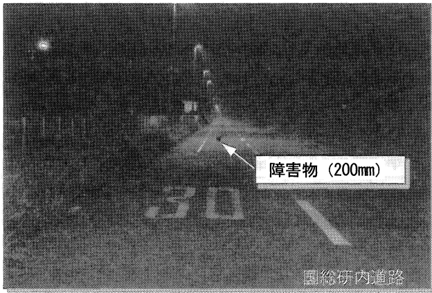
写真-4 照明環境例（設置間隔約4.5H）
