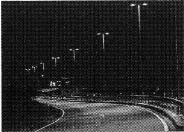
写真-1 連続照明の整備例（中央帯配置）
