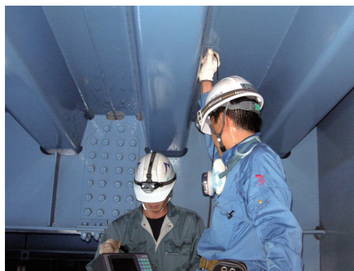
写真 4.3-4 超音波探傷試験
