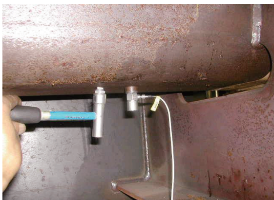
写真 3.8-5 打音計測装置
