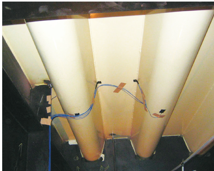
写真 3.10-4 ひずみゲージ設置位置の例
