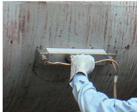
(b) 加熱ヒータ（ハロゲンランプ）
