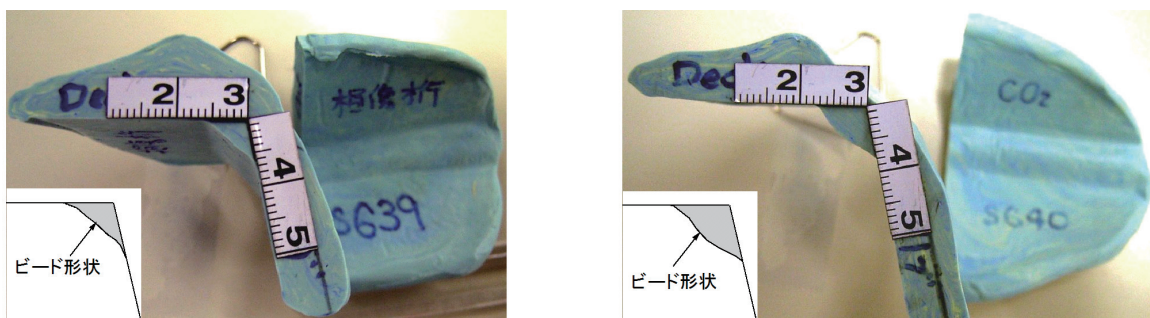
a) ビード貫通き裂が発生した溶接部
