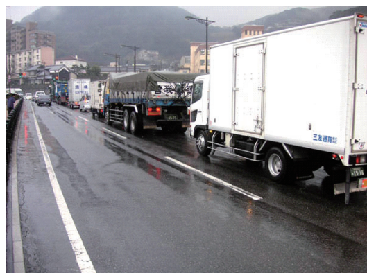
写真 3.4-7 橋梁の前方に交差点がある場合の第二車線への大型車の集中例
