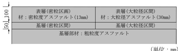
図-2 既設舗装断面図
