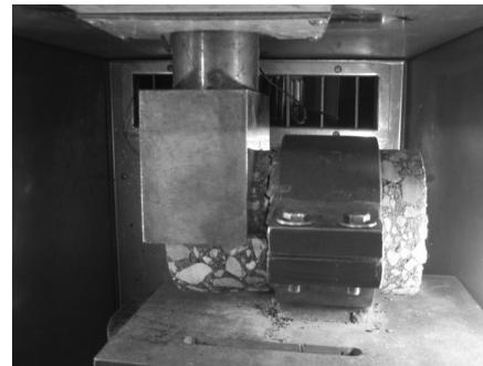
写真-4せん断強度試験状況
