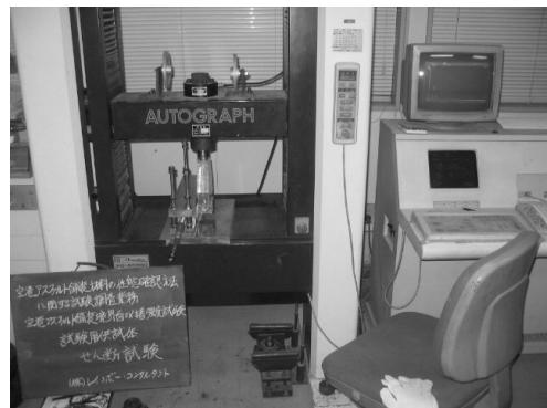
写真-10 せん断強度試験状況
