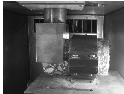
写真-4せん断強度試験状況
