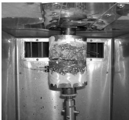
写真-3 引張強度試験状況
