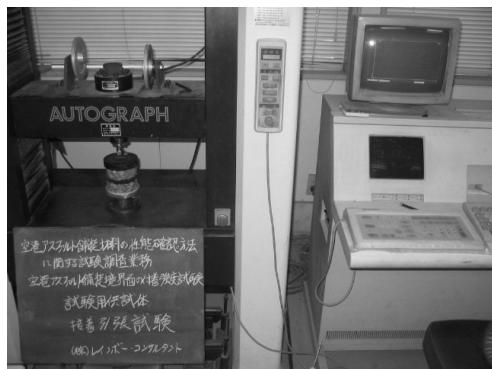
写真-9 引張強度試験状況
