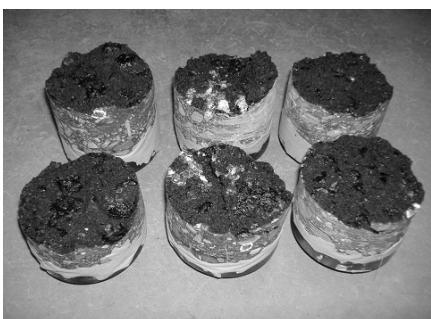
写真-5 改質系乳剤使用時の破断状況
