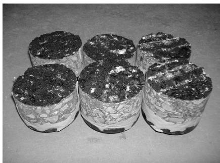
写真-6 PK-4 使用時の破断状況
