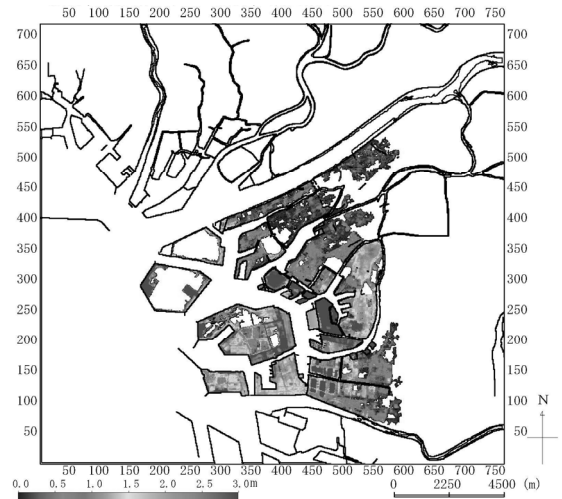
付図 C-11 台風強度 1.3 で海面上昇 80cm の場合
