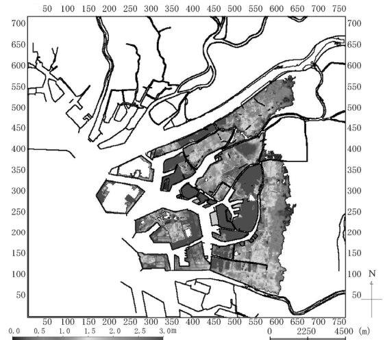
付図 C-17 台風強度 1.6 で海面上昇 80cm の場合
