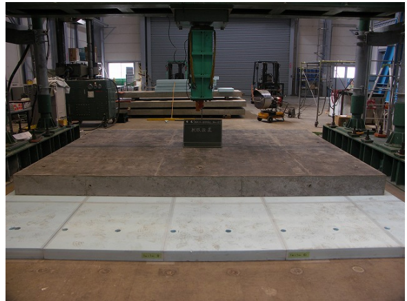
枕版の設置状況
