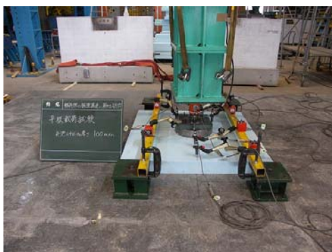
模擬路盤（発泡スチロール）の平板載荷試験の状況
