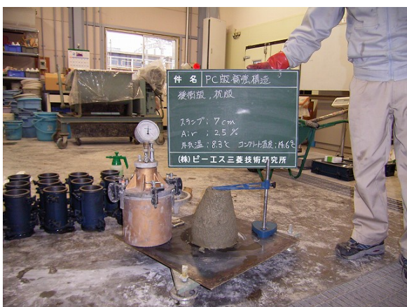
枕版・緩衝版コンクリートのフレッシュ性状試験
