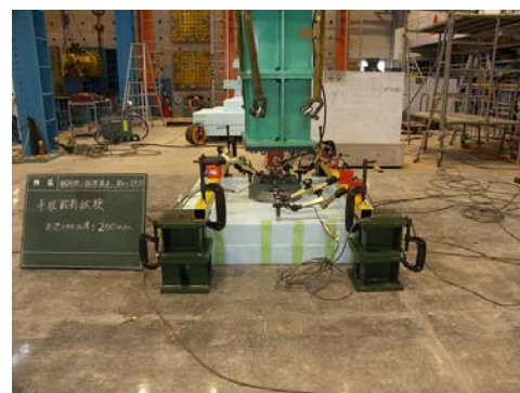
模擬路盤（発泡スチロール）の平板載荷試験の状況
