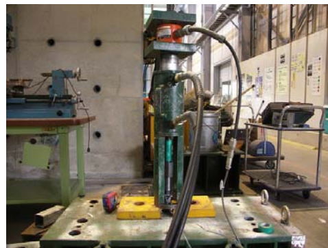
ボルトの引張試験の状況
