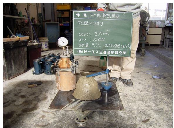
PC版コンクリートのフレッシュ性状試験
