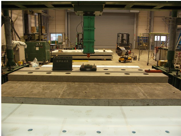
緩衝版の設置状況
