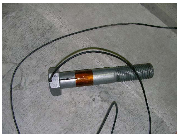
図-88 ボルトゲージの状況と荷重とひずみの較正結果
