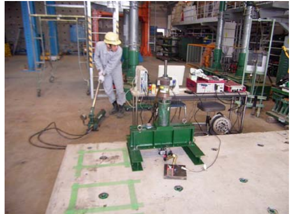
写真-21 引抜き試験状況
