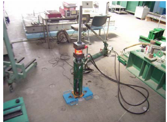
写真-20 ボルトキャリブレーション状況
