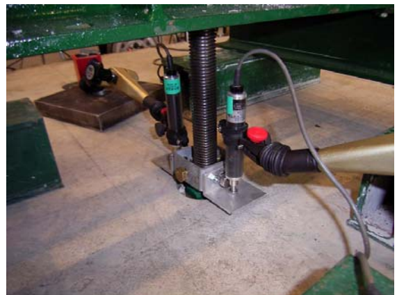
写真-22 変位測定状況
