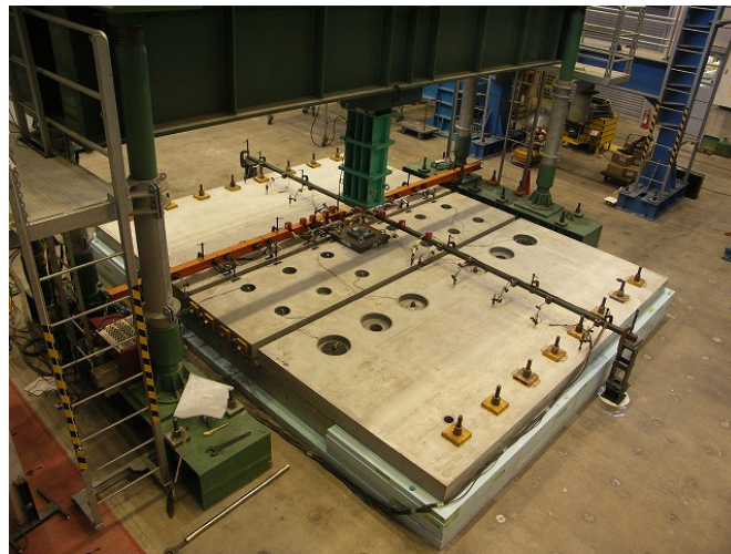
写真-10 静的載荷試験の状況
