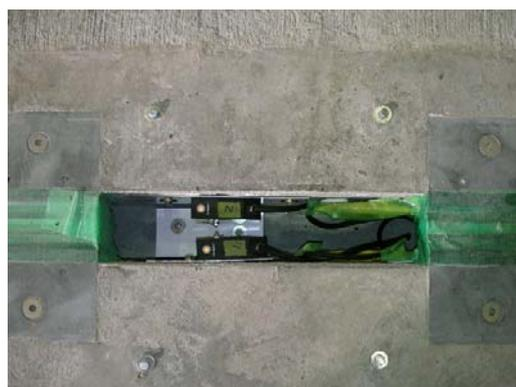
写真-24 レーザー変位計の設置状況
