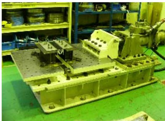
写真-1 伸縮性能確認試験状況（日変化）
