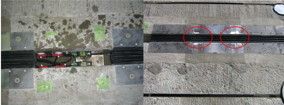
(a) 地下水有, ボルト締結無の 50 回走行後の水の噴出 (b) 目地構造のプレートとゴムの摩耗
