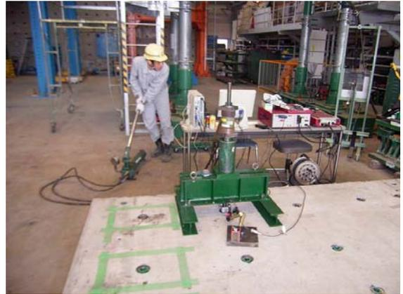
写真-21 引抜き試験状況
