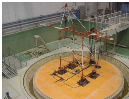
写真-4.1 クレーン模型および振動台全景
