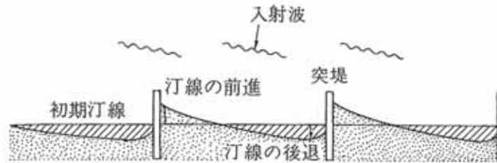
■突堤工法による海浜の安定化（出典5-1）
