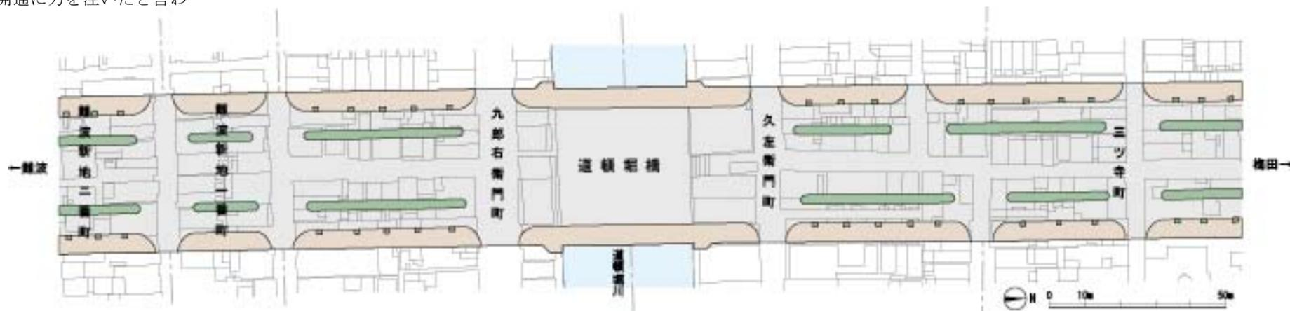
道頓堀川付近の拡張図面 旧御堂筋と比較して大きく幅員が広がっており、相当数の立ち退きが発生したことが見てとれる。
