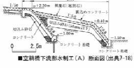
■空鞘橋下流部水制工(A) 断面図(出典7-18)
