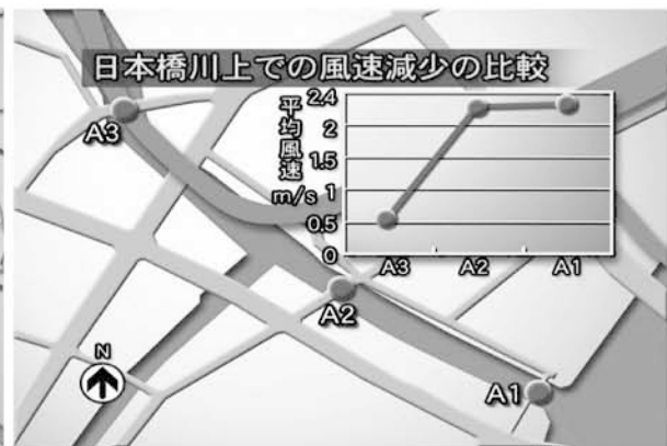
図6 高架道路下における風速の低下
