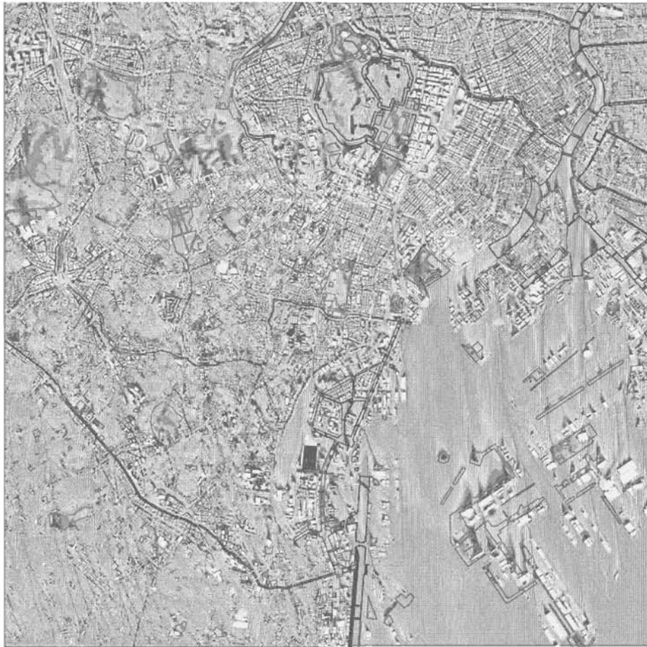
図 18 地球シミュレータによる東京臨海・都心部 10km 四方のシミュレーション結果 （2005 年 7 月 31 日 14 時の地上高さ 10m の風向・風速分布を再現したもの）
