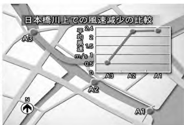
図6 高架道路下における風速の低下
