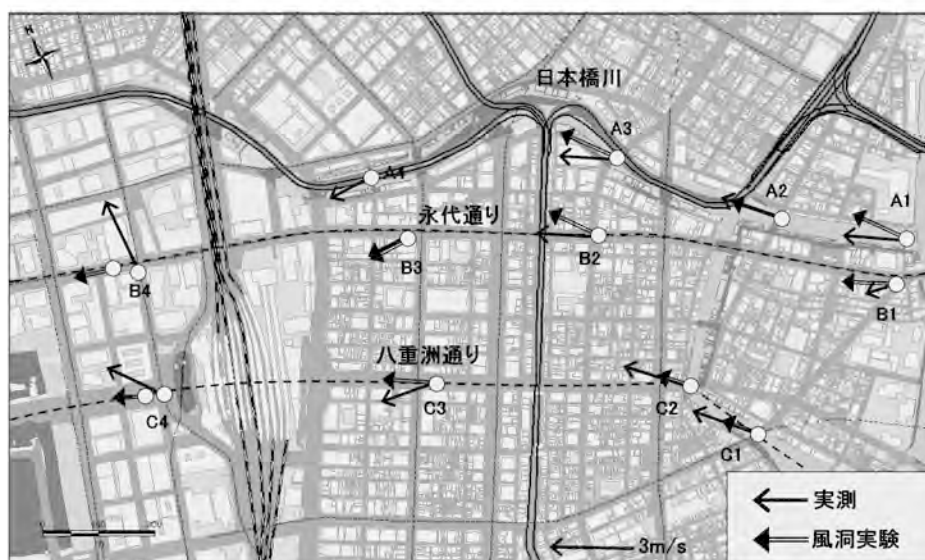
図 12 風洞実験と実測調査による風速・風向の比較
