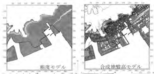
図-7 粗度モデルと合成地盤高モデルの 地盤高の比較
