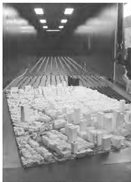
図9 風洞内部と市街地模型
