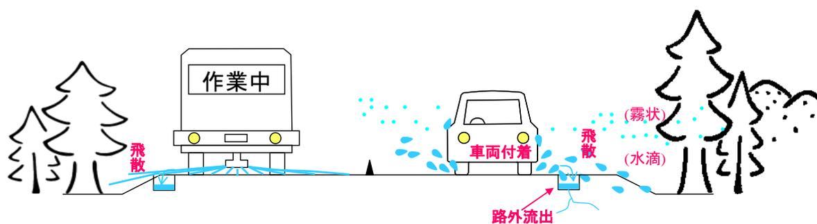
図3-1-1 散布した凍結防止剤の飛散状況イメージ図
