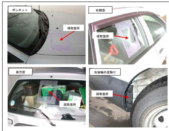
図3-1-11 車両付着量の調査方法
