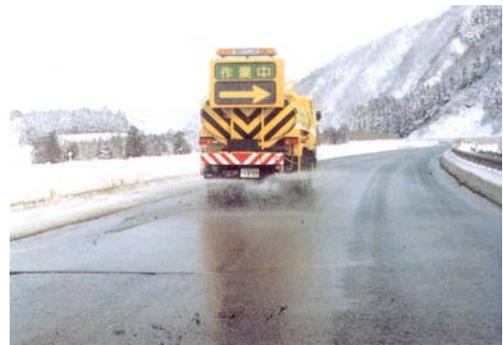
図 2-4-4 溶液散布車（散水車）
