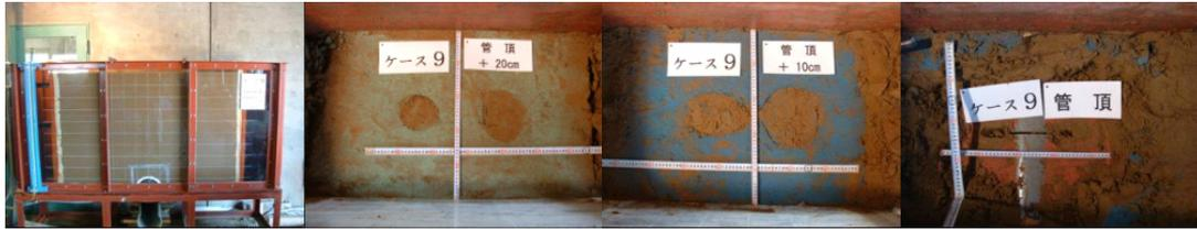
写真 14 case5 ゆるみ観測状況(管頂 20、10、0cm)
