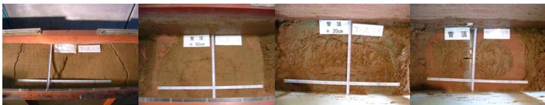
写真 18 case9 ゆるみ観測状況(管頂 90、60、20、0cm)
