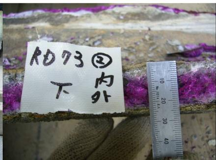
写真6 管厚・中性化深さの測定
