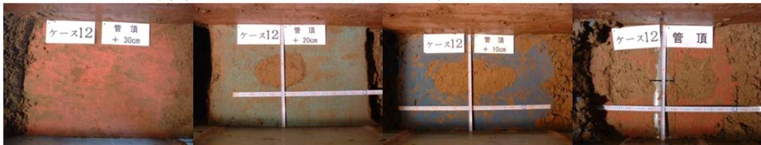
写真 17 case8 ゆるみ観測状況(管頂 30、20、10、0cm)
