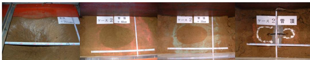
写真11 case2 ゆるみ観測状況(管頂90、60、20、0cm)
