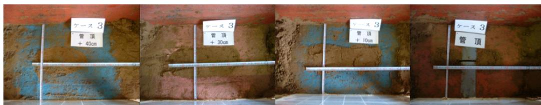
写真12 case3 ゆるみ観測状況(管頂40、30、10、0cm)
