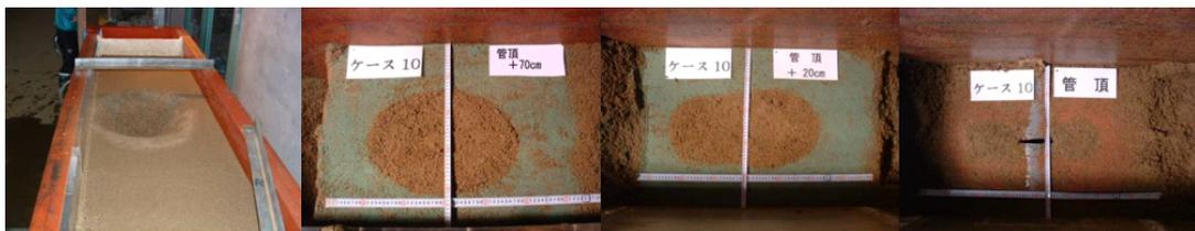
写真 15 case6 ゆるみ観測状況(管頂 90、70、20、0cm)
