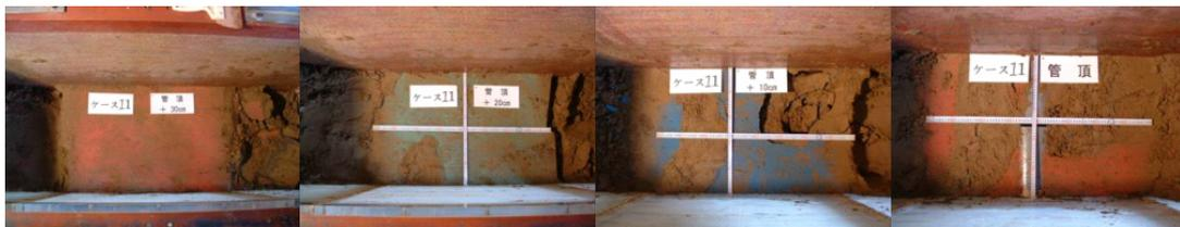
写真 16 case7 ゆるみ観測状況(管頂 30、20、10、0cm)
