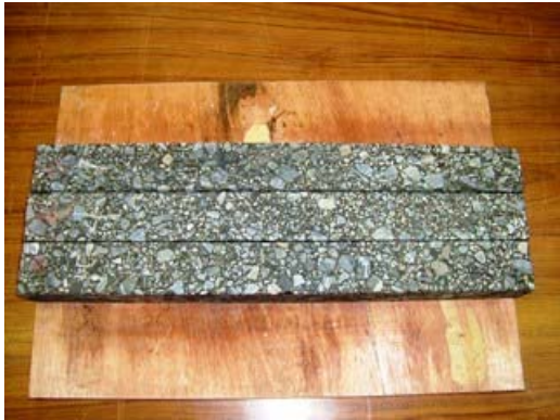
写真-2 整形後供試体
