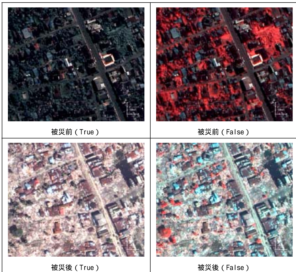
図 2-3-24 目視による被害判読 ( 事例 4 : 構造物の崩壊 )
